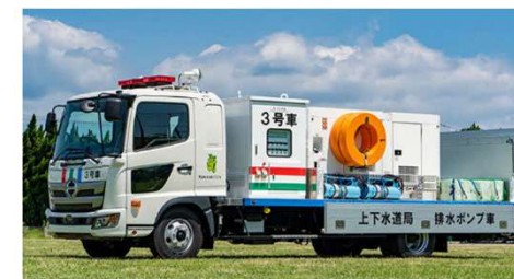
排水ポンプ車 30m 3 /分
